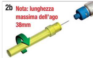
2b. Rimuovere il cappuccio posteriore dell'ago e avvitare l'ago sull'adattatore fino a fondo corsa.
