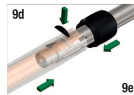
9d. Riposizionare un nuovo manicotto, inserire la linguetta di sicurezza, spingere verso l'interno e slittare il collare a chiudere.
