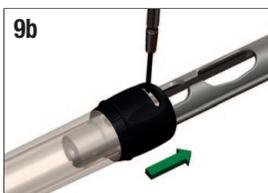
9b. Inserire uno strumento adatto nel foro del collare, spingere e separare il collare dal manicotto.
